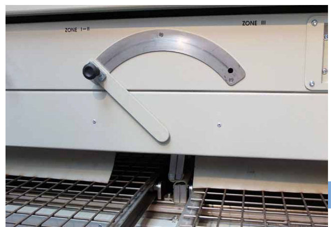
Klapka pro rozdělení vyhříváního prostoru na dvě samostatné zóny
