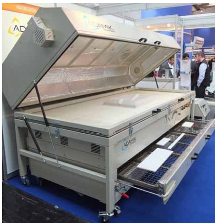
Kombinovaný membránový lis s nahřívací pecí ADAMIK Combiformer Plus pro termoforming i dýhování
