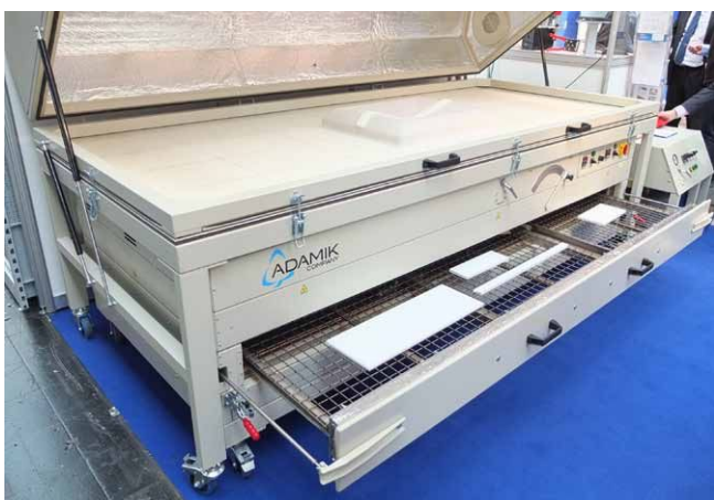
Zásuvkový systém zavírání vyhříváního prostoru
